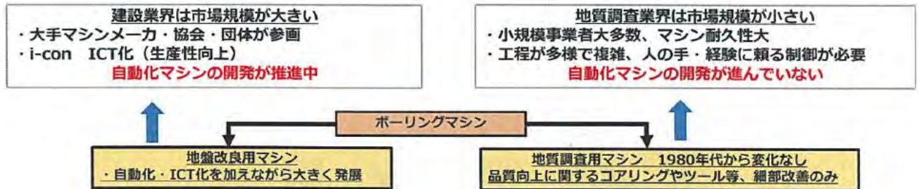
図-6 地盤改良用と地質調査用ボーリングマシンの比較
