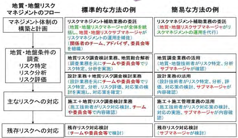
図-9 地質・地盤リスクマネジメントの実施イメージ(国土交通省・土木研究所)
